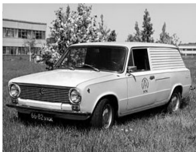
Электромобиль VAZ-2102Э (1976 г.) — советская экспериментальная модель электромобиля, выпущенная малой серией, предназначенная для перевозок небольших партий грузов.
